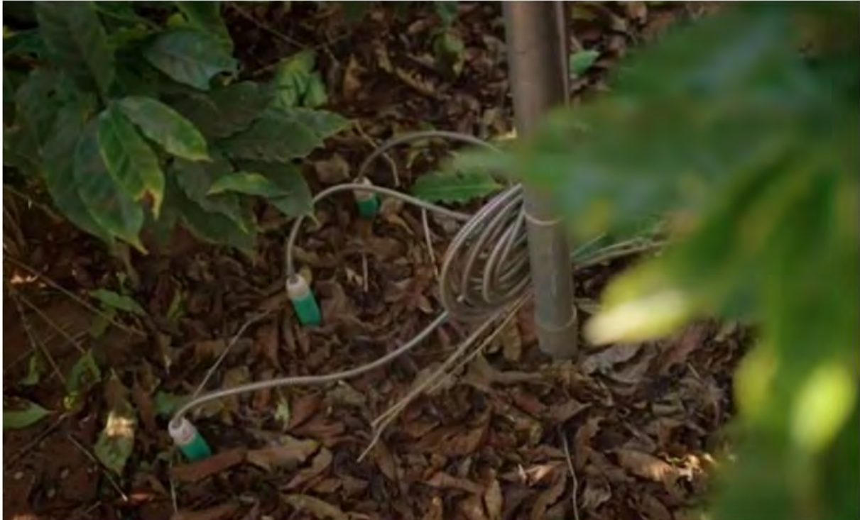
Sensores de humedad y temperatura del suelo, y el agua recibida por la lluvia
