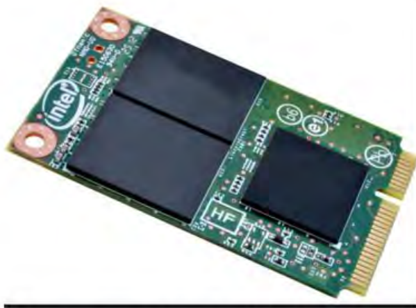
Unidad e estado sólido (SSD) basada en NAND. La compuerta NAND o NOT AND es una puerta lógica que produce una salida falsa solamente si todas sus entradas son verdaderas; por tanto, su salida es complemento a la de la compuerta AND.
