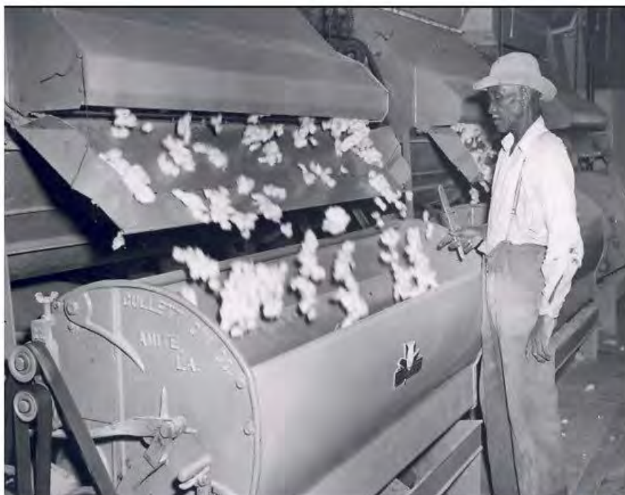
Trabajador frente a una caja de desmotadora, en la década de 1940. Las motas de algodón ya desmotado caen en cascada. A la izquierda, se ve las bandas de trasmisión de fuerza.
