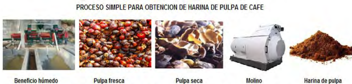
Figura 4. Esquema simple para obtener harina de pulpa de café. (Elaboración propia: G. Bendaña)
