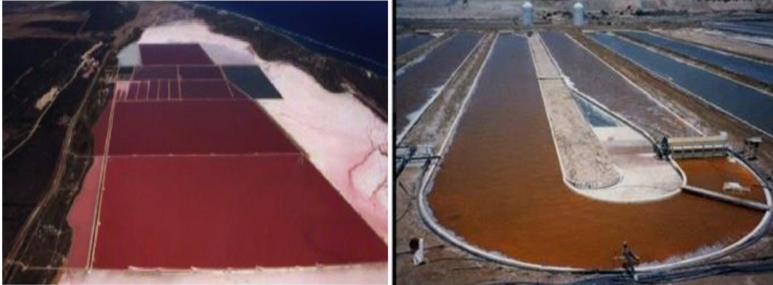
Fotos 10 y 11. Biorreactor abierto tipo open ponds (izq.) y biorreactor abierto tipo raceway (der.) (12).
