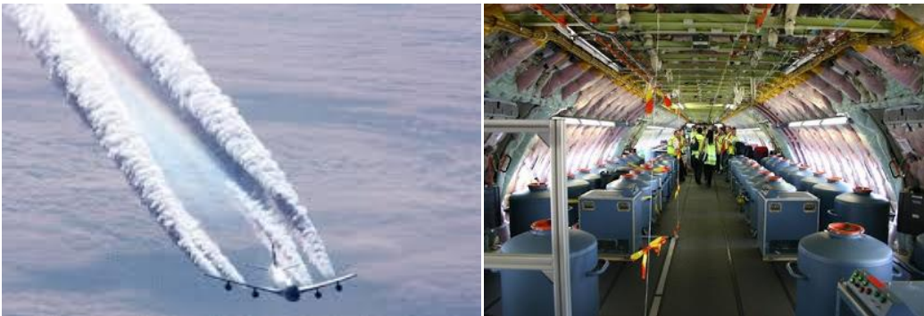
Fotos 5 y 6. Avión en labor de rocío de sulfatos (izq.); Interior de un avión preparado para rocío de sulfatos (der.)
