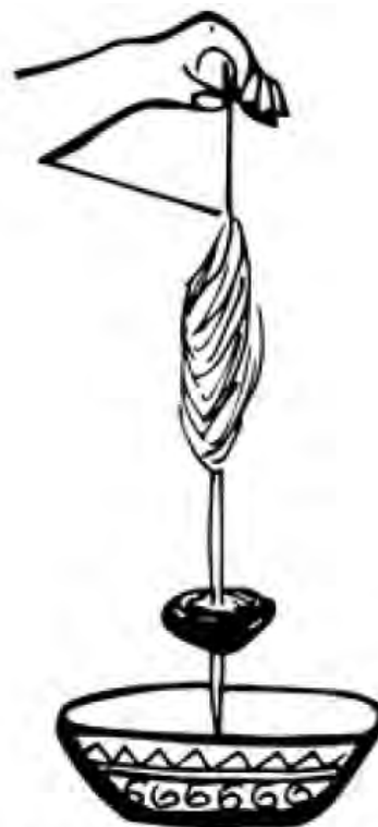
Figura 25.1 Hilatura con soporte con eje de madera y espiral de disco en un recipiente giratorio (Charney 1887). Redibujado por Kristin Sullivan.
