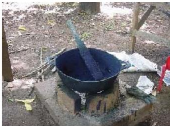
Figura N° 15. Perol para realizar la cocción de la pasta de añil.
