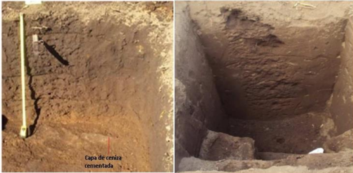
Izquierda: Suelo franco arenosos con capa limitante de ceniza volcánica cementada a los 60 cm de profundidad, comarca Cosmapa, Chinandega. Derecha: Suelo franco arenoso fino, profundos (más de 2 m), comarca La Gloria, Chinandega. (Fuente: archivo personal del autor).
