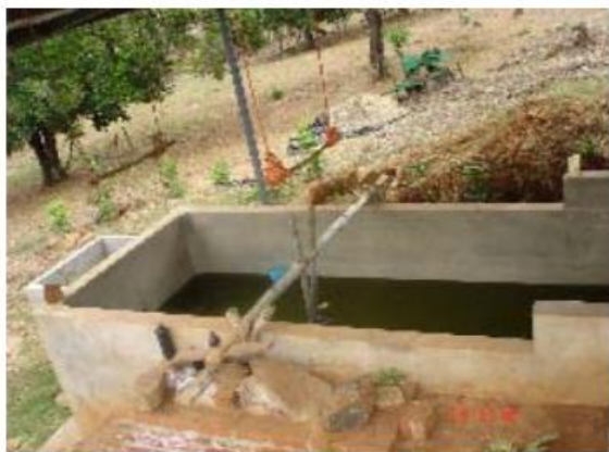
Figura N° 12. Pila de oxigenación con paleta de zangarro. Hacienda La Perla, Cantón Rojitas, Sensuntepeque Cabañas.
