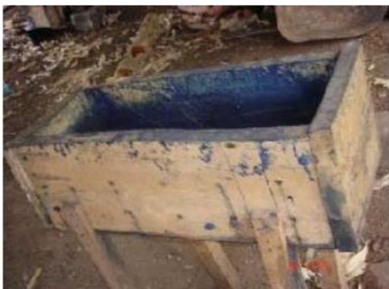
Figura N° 16. Cajón de madera para el prensado de la pasta de añil. Hacienda La Perla, Cantón Rojitas, Sensuntepeque, Cabañas.
